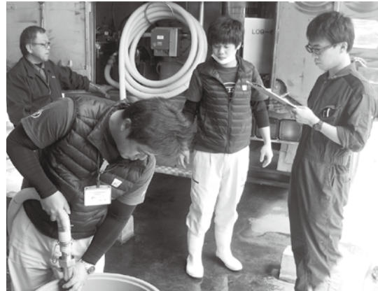
(電磁流量計の精度管理検査を行う広酪職員)
